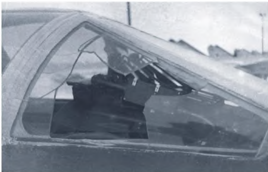
Разрушение остекления самолета капитана Быкова А.Ю.
